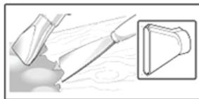
**А. Удаление лакокрасочных покрытий, разъединение клеевых соединений.**
